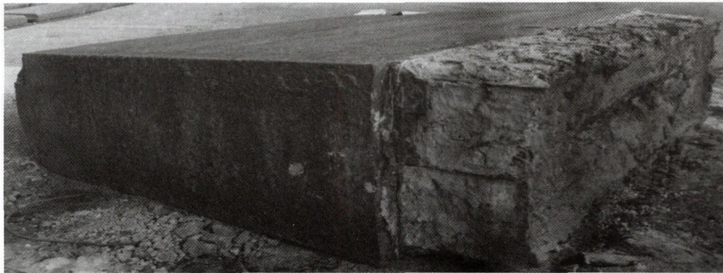
图 3 61 t 水冷扁锭形貌 Fig. 3 Morphology of 61 t water cooling flat ingot
